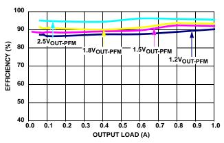
FIGURE 4. EFFICIENCY vs LOAD (1MHz 3.3 V<sub>IN</sub> PFM)
