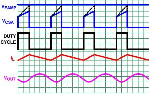
FIGURE 35. PWM OPERATION WAVEFORMS
