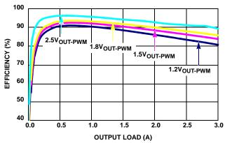
FIGURE 3. EFFICIENCY vs LOAD (1MHz 3.3 V<sub>IN</sub> PWM)
