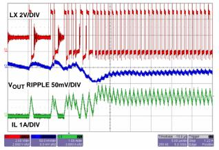
FIGURE 20. MODE TRANSITION DCM TO CCM
