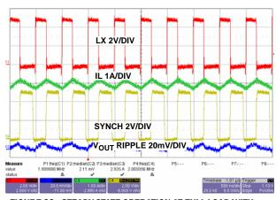
FIGURE 29. STEADY STATE OPERATION AT FULL LOAD WITH FREQUENCY = 2MHz
