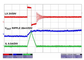
FIGURE 17. STEADY STATE OPERATION AT NO LOAD (PFM)
