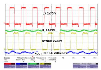
FIGURE 31. STEADY STATE OPERATION AT FULL LOAD (PWM)
