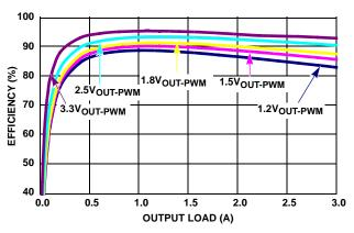
FIGURE 5. EFFICIENCY vs LOAD (1MHz 5V<sub>IN</sub> PWM)
