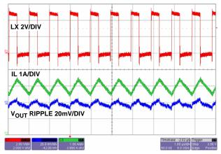
FIGURE 18. STEADY STATE OPERATION WITH FULL LOAD
