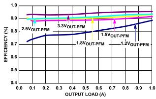
FIGURE 6. EFFICIENCY vs LOAD (1MHz 5V<sub>IN</sub> PFM)
