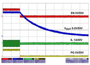
FIGURE 27. SOFT-DISCHARGE SHUTDOWN
