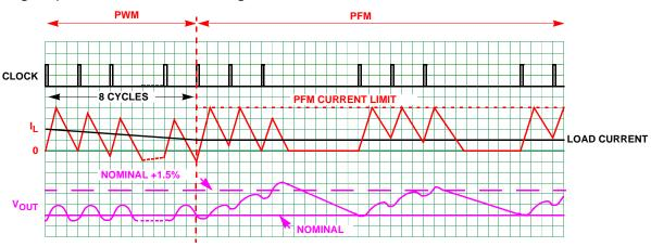
FIGURE 36. SKIP MODE OPERATION WAVEFORMS
