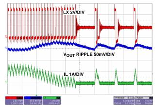
FIGURE 19. MODE TRANSITION CCM TO DCM
