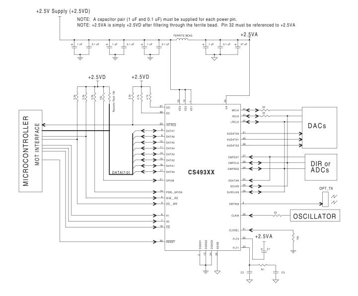
Figure 18. Motorola<sup>®</sup> Parallel Control Mode
