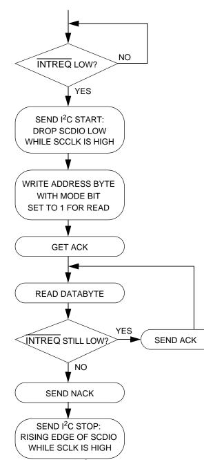
Figure 23. I<sup>2</sup>C<sup>®</sup> Read Flow Diagram
