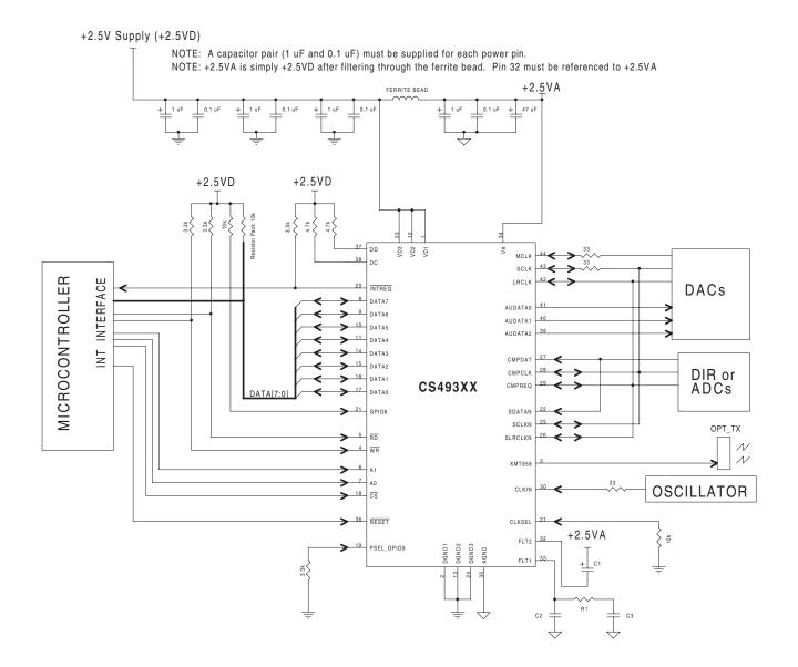
Figure 17. Intel<sup>®</sup> Parallel Control Mode
