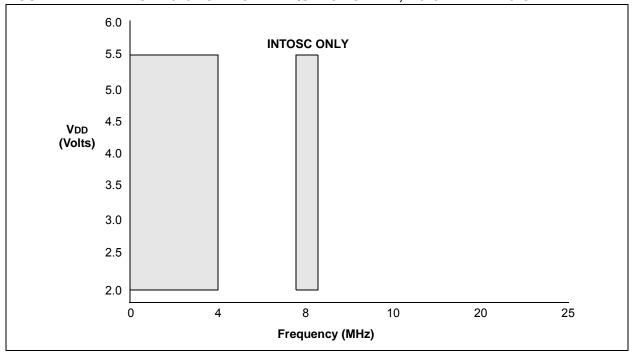
FIGURE 11-2: MAXIMUM OSCILLATOR FREQUENCY TABLE
