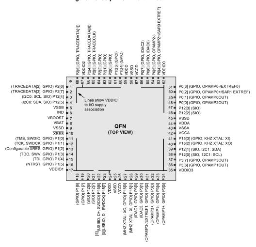
Figure 2-3. 68-pin QFN Part Pinout<sup>[4]</sup>
