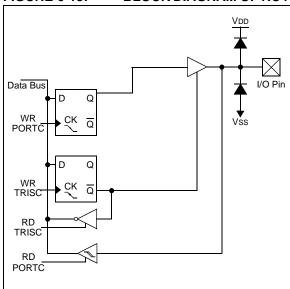
FIGURE 6-14: BLOCK DIAGRAM OF RC5
