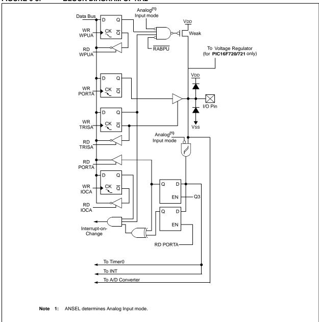
FIGURE 6-4: BLOCK DIAGRAM OF RA3
