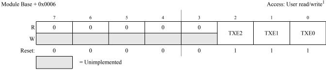
Figure 18-10. MSCAN Transmitter Flag Register (CANTFLG)
