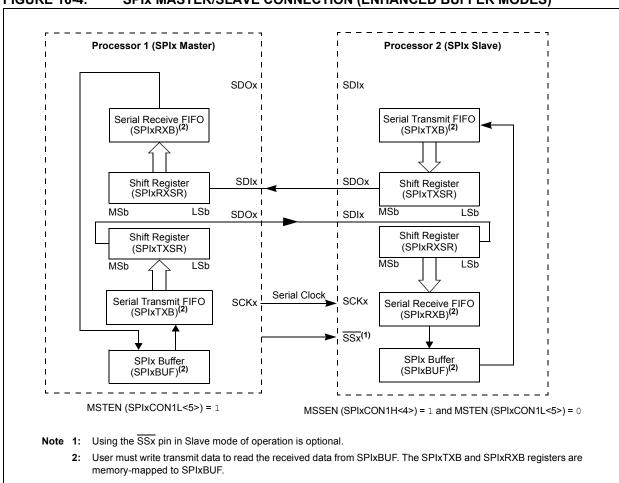
FIGURE 16-4: SPIX MASTER/SLAVE CONNECTION (ENHANCED BUFFER MODES)
