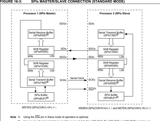
**FIGURE 16-3:** SPIX MASTER/SLAVE CONNECTION (STANDARD MODE)
