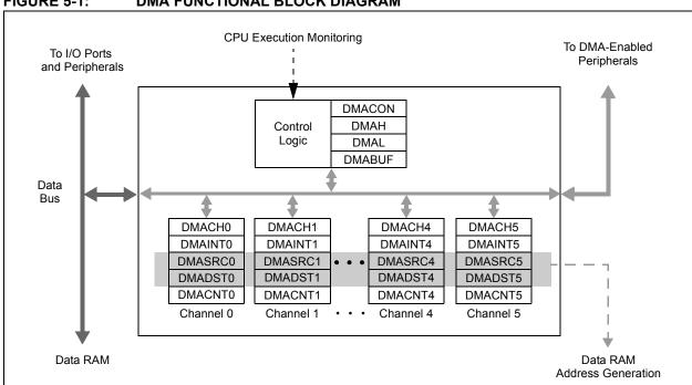
FIGURE 5-1: DMA FUNCTIONAL BLOCK DIAGRAM
