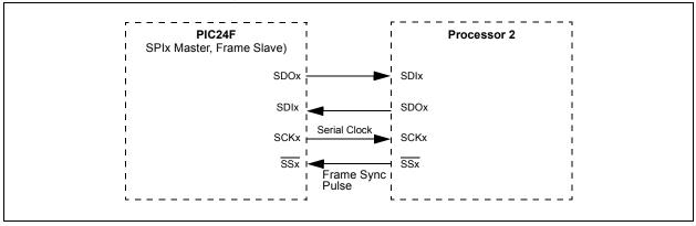
FIGURE 16-7: SPIX SLAVE, FRAME MASTER CONNECTION DIAGRAM
