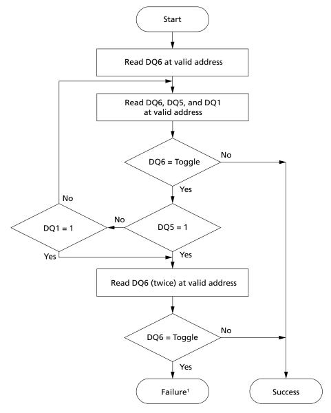
Note: 1. Failure results: DQ5 = 1 indicates an operation error; DQ1 = 1 indicates a WRITE TO BUFFER PROGRAM ABORT operation.
