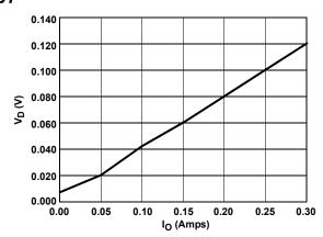
FIGURE 1. LD02 DROPOUT VOLTAGE
