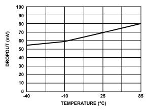
FIGURE 18. LD03 DROPOUT VOLTAGE vs TEMPERATURE
