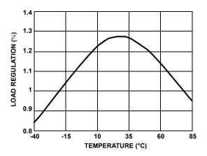
FIGURE 11. LD03 LOAD REGULATION vs TEMPERATURE
