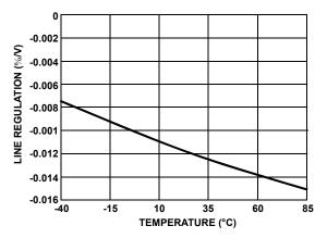
FIGURE 14. LD03 LINE REGULATION vs TEMPERATURE
