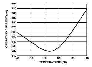
FIGURE 16. OPERATING CURRENT vs TEMPERATURE
