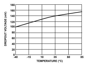
FIGURE 17. LD02 DROPOUT VOLTAGE vs TEMPERATURE
