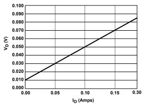
FIGURE 2. LD03 DROPOUT VOLTAGE
