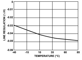
FIGURE 13. LD02 LINE REGULATION vs TEMPERATURE
