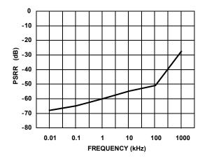
FIGURE 20. POWER SUPPLY REJECTION RATIO vs FREQUENCY
